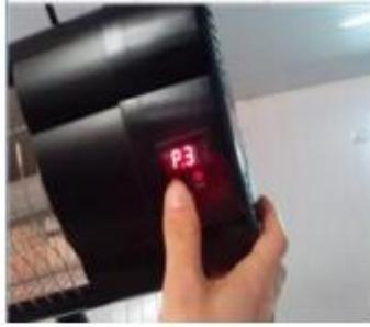
Étape 6 : Après l'activation de la fonction, la synchronisation d'arrêt 1-24 heures peut être ajustée de façon arbitraire, l'écran numérique montrant 0,1 correspond à une durée d'une heure, celui-ci montrant 0,2 correspond à une durée de deux heures.
